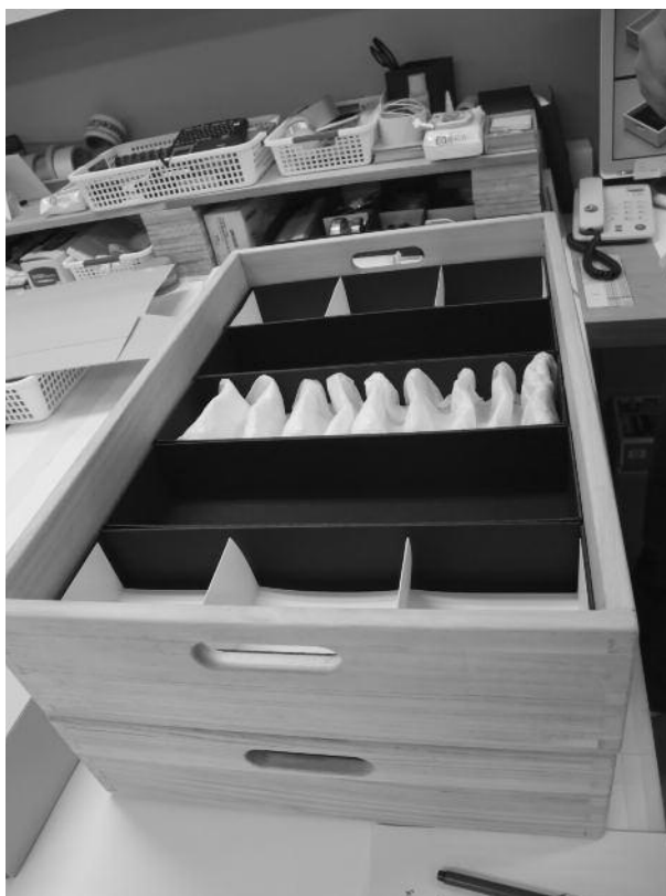
Obr. 13. Výroba škatúl z pH neutrálnych materiálov na uloženie zbierkových predmetov. Foto M. Sedláčková, 2011
