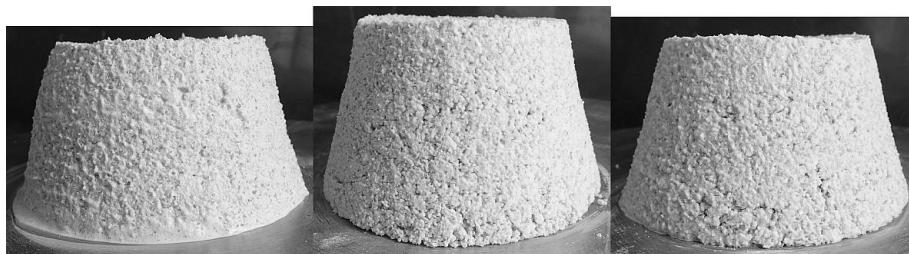
Obr. 7: Vzhled kuželů malt po dokončení rozlivové zkoušky – zleva VH, VH24h, VH5m.
