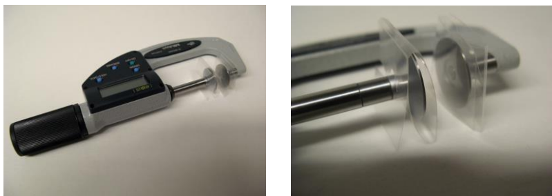
Obr. 4: Mikrometer Mitutoyo 369-411 PDM-30 QM opatrený stacionárnymi ochrannými návkami vyrobenými z tenkej polyesterovej fólie.
