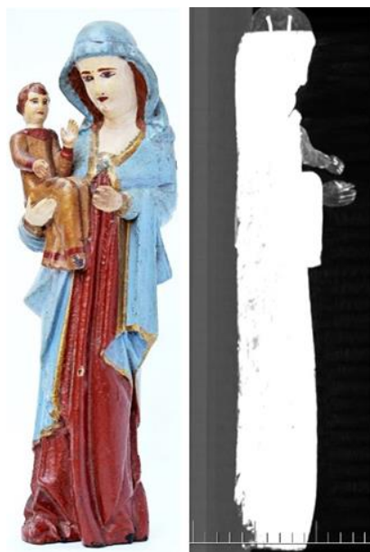
Obr. 4 a, b: Socha madony v stave pred reštaurovaním (a), MIP z CT prístroja Siemens Somatom Sensation 64, TomoCon freewar, 648 axiálnych snímok, 120 kV, 71 mA, 25 mAs (b).
