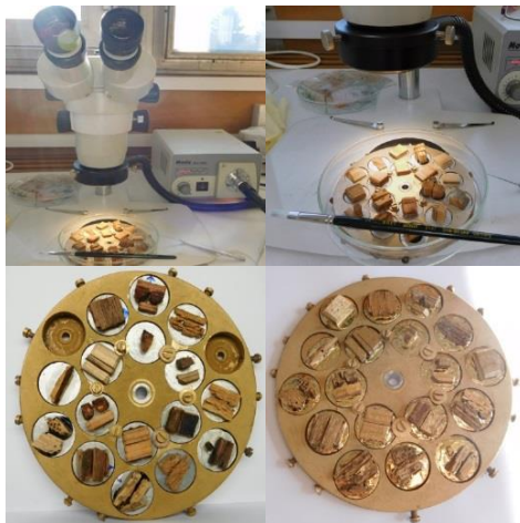
Obr. 3: Preparáty pre skenovaciu elektrónovú mikroskopiu pred a po pozlátení 24K zlatom.
