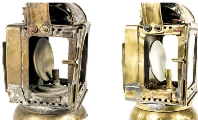
Obr. 2: Konzervování – restaurování Karbidové drážní lucerny, cca 1920 – 1924 (restauroval: Jan Růžička, vedoucí práce: Ing. Šárka Msallamová, Ph.D., Ing. Václav Nikendey – restaurátor s licencií MK ČR, 2017).
