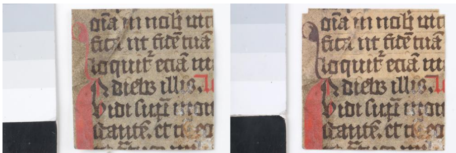
Obr. 1: Vzorka historického písacieho pergamentu čisteného laserom pri nastavení vlnovej dĺžky 1064 nm (vľavo pred čistením, vpravo po čistení). Autor snímok: MgA. Radka Benžová
