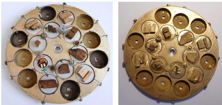
Obr. 2: Preparáty pre skenovaciu elektrónovú mikroskopiu pred pokovením (a) a po pokovení 24K zlatom (b).
