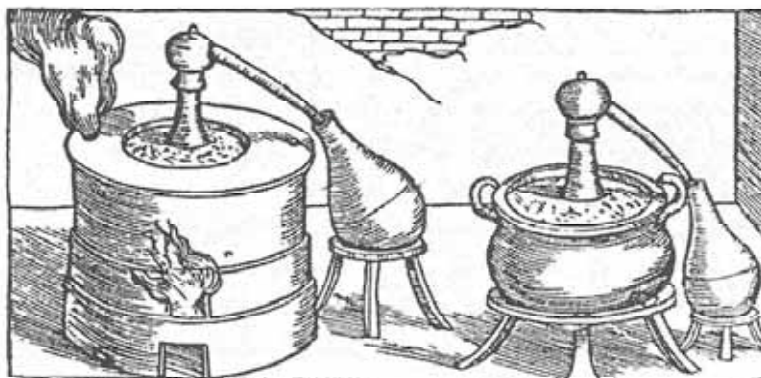
Obr. 3 Destilačná súprava zo 16. storočia zobrazená v prvej edícii Biringuccio: Pirotechnia – vydané v roku 1540 v Benátkach (podľa Zecchin 1989, 179)
