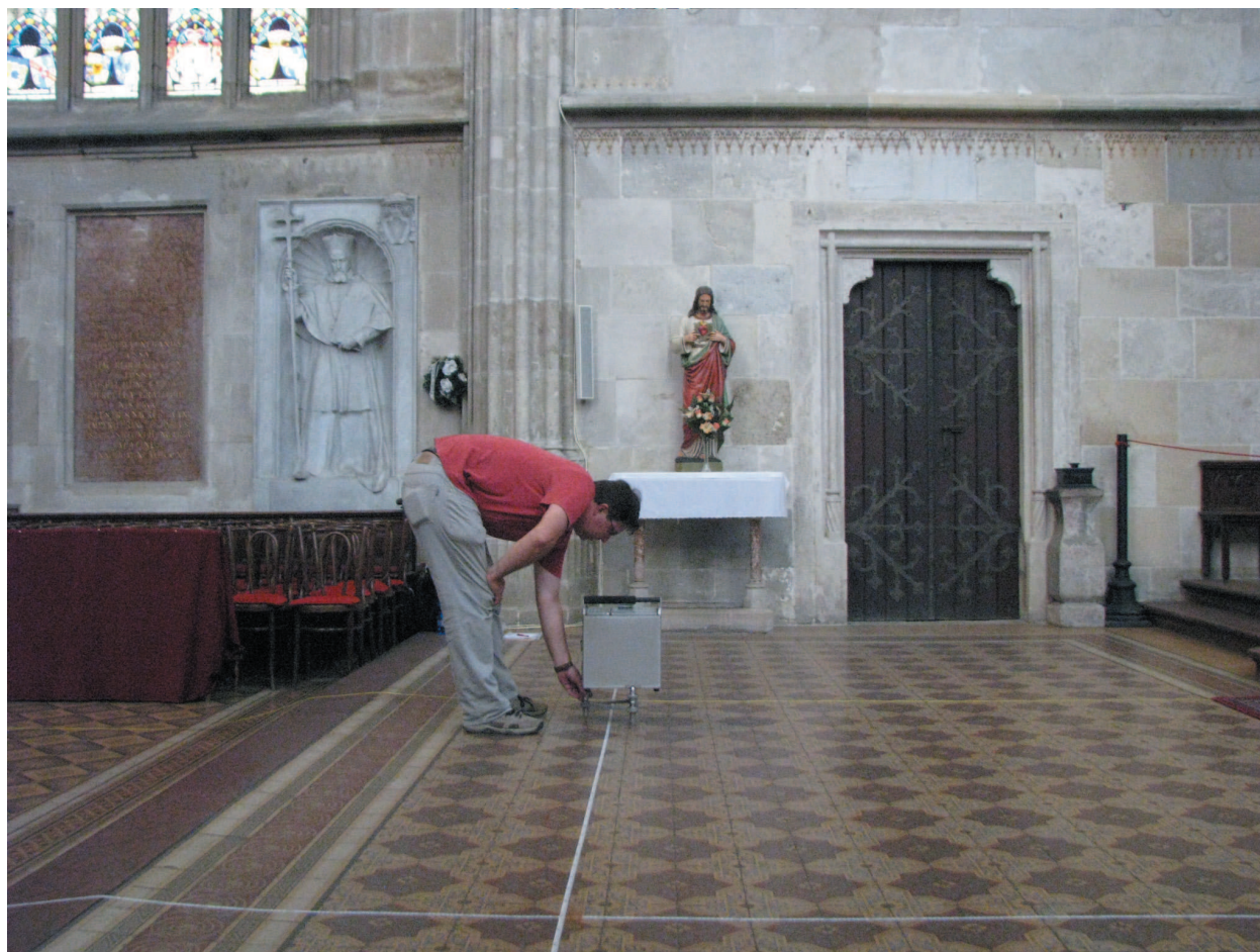
Obr. 11 Meranie pomocou gravimetra – s aparátúrou Scintrex CG-3M. Abb. 11 Gravimetermessung – Apparatur Scintrex CG-3M.
