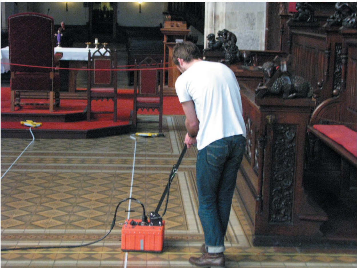
Obr. 10 Meranie pomocou georadaru – s aparátúrou GSSI SIR-3000 s 400 MHz anténou. Abb. 10 Georadarmessung - Apparatur GSSI SIR-3000 mit einer 400 MHz Antenne (Foto: I. Choma).
