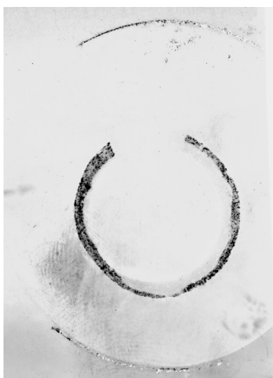
Obr. 5 Hlaveň pištole z 18. storočia z dvoch druhov materiálu, jej vonkajšia vrstva na rozdiel od vnútornej obsahuje síru
